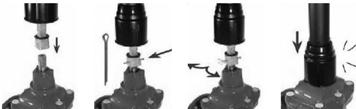
Рис. 4 Порядок установки телескопического штока на задвижку.
