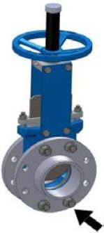
2. Пододвинуть фланцы на шпильки и слегка привернуть с помощью четырех гаек.
